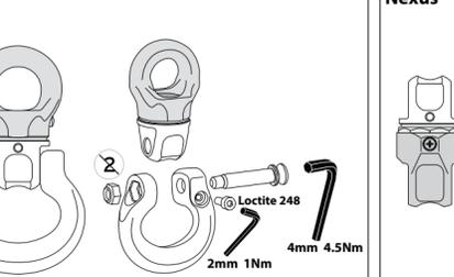
EN Nylon nuts must be replaced if removed. NO Nylstop muttere må erstattes hvis fjernes. SV Nylstop muttrar skall bytas ut om avlägsnas. FI Nylstop mutterit on vaihdettava jos se on irrotettu. DK Nylstop nødder skal udfikses, hvis fjernes. PL Orzechy nylstop należy wymienić, jeśli usunie. CZ Nylstop matice se musí vyměnit, pokud odstraní. SK Nylstop matice sa musia vymeniť, ak odstránia.
